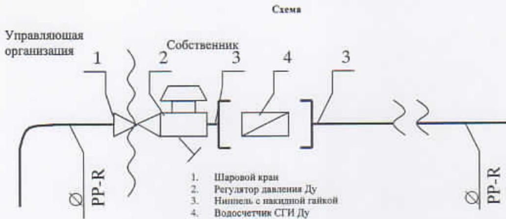
Исполнитель несет ответственность за надлежащее состояние и работоспособность систем горячего и холодного водоснабжения согласно нижеуказанной схеме до волнистой линии слева (включая шаровый кран).
