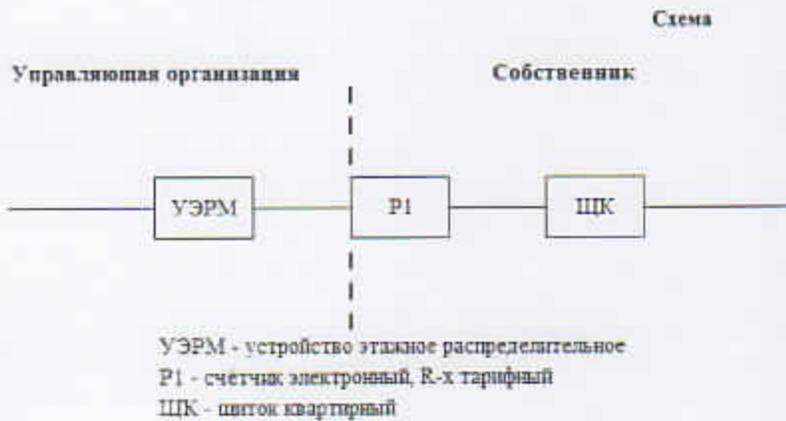
Исполнитель несет ответственность за надлежащее состояние и работоспособность питающих электрических сетей на квартиру согласно нижеуказанной схеме до прибора учета (пунктирной линии слева).
